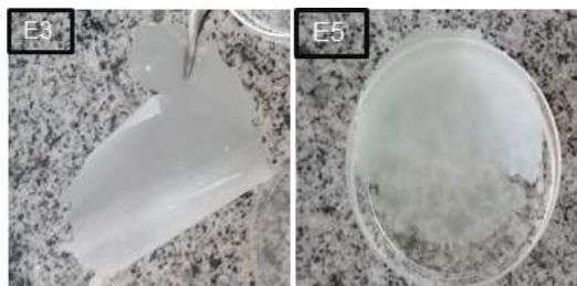
Figura 2. Fotografias das membranas de quitosana/indometacina obtidas pelo método sol-gel com etanol
